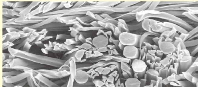
繊維断面の電子顕微鏡写真
